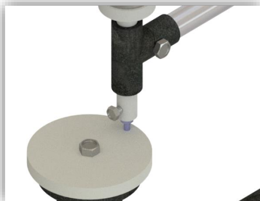
Fig. 3. Detalle modelado del dispositivo de desgaste Pin on Disk.
