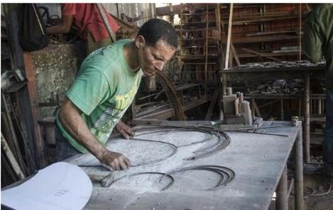
Anexo 8: Montaje de la herrería sobre los bastidores de madera.
