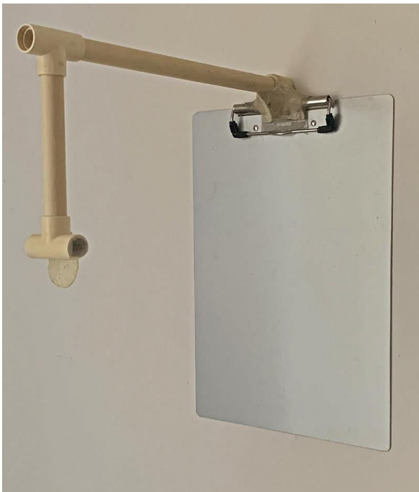
Imagen 4.- Fotografía del prototipo de la Cámara lúcida digital propuesto en este estudio.
