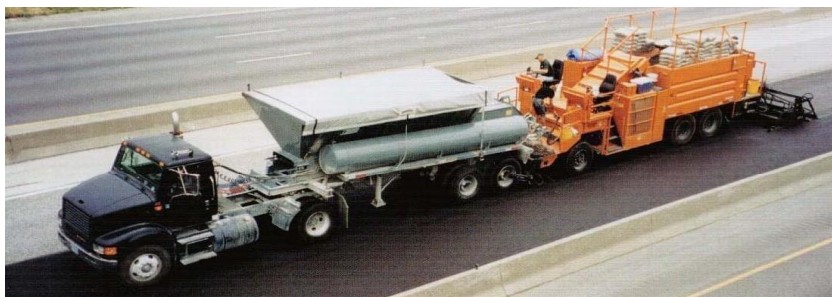
Figura 1: Máquina típica de aplicación continua de micro-pavimentos.
