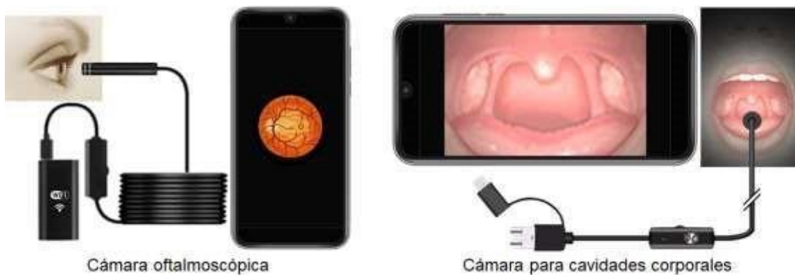
Figura 14. Cámaras para la observación del fondo de ojo y otras cavidades corporales.
