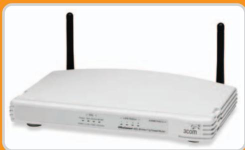
todos los que conocemos tienen un mecanismo para poder reiniciarlos a su configuración de fábrica. Así, por ejemplo, en algunos basta con encenderlos mientras se mantiene pulsado el botón de *reset* durante unos segundos. En otros tendremos que ajustar un interruptor trasero mientras lo encendemos e, incluso, un modelo de Thomson se reinicia encendiéndolo y volviendo a pulsar
