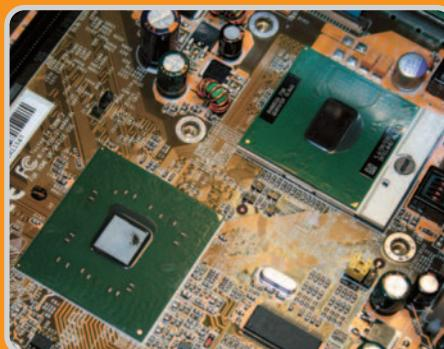
Detalle del Pentium M 755 sobre el Socket 479, junto al chipset i915GM. A ambos se les han retirado sus disipadores.
