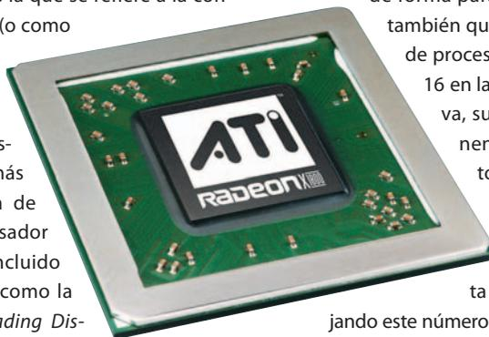
xeles en hilos (conjuntos) de 4x4 píxeles. Estas áreas se procesan muy rápidamente y de forma paralela, permitiendo también que, si alguna unidad de proceso de píxeles (hasta 16 en la X1800) está inactiva, sus recursos se asignen a otro hilo distinto. Hasta 512 hilos pueden ser tratados simultáneamente en la tarjeta de gama alta, bajando este número a 128 en el caso de las X1600 y X1300. Otra mejora crítica a la hora de manejar los *pixel* y *vertex shaders* es la
