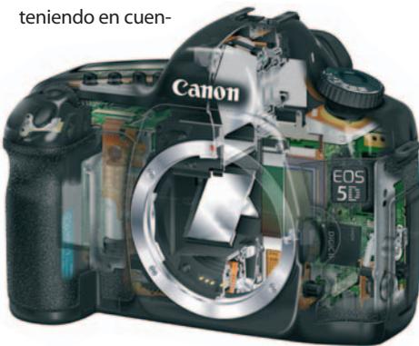
Superado el alto coste, la implantación de sensores *full frame* en las cámaras réflex digitales (como la EOS 5D «destripada» en esta foto) supone ganar en calidad de imagen, con menores niveles de ruido y una gama tonal más amplia. Además, permite mantener invariable el ángulo de visión de los objetivos analógicos, conservar los visores mucho más luminosos de las réflex de 35 mm y mantener las posibilidades de control de la profundidad de campo.
