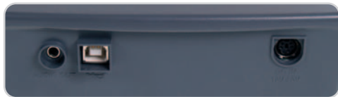
En su parte posterior encontramos el conector de alimentación, el del USB 2.0 y una salida de audio directa para altavoces.
