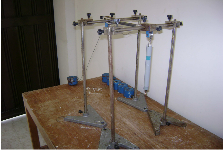
Montaje prueba de adhesividad
