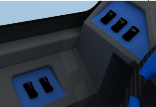
Control de apertura de luces y puertas
