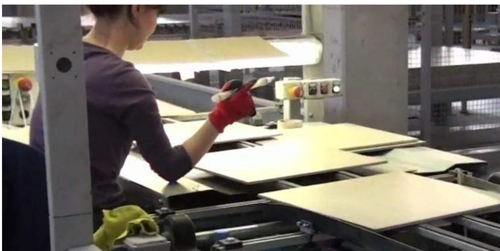
Ilustración 58 Clasificación manual de baldosas a la salida de la línea de producción
