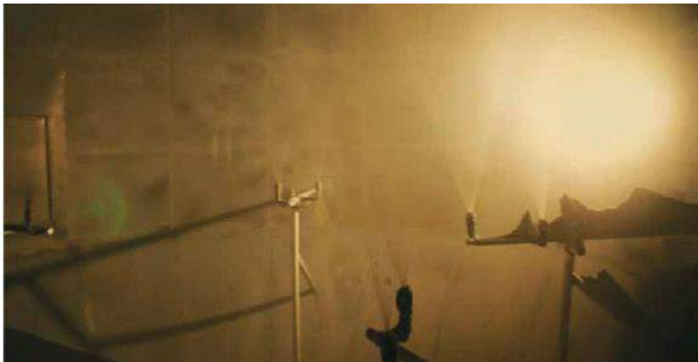
Ilustración 20 Interior de un atomizador (corona expulsando la barbotina a presión)
