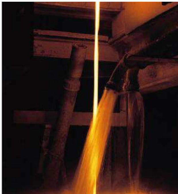
Ilustración 35 Enfriamiento de frita con agua.
