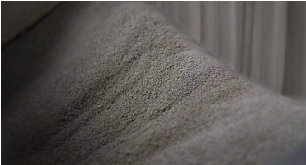
Ilustración 21 Barbotina convertida en polvo cerámico luego del proceso de atomización
