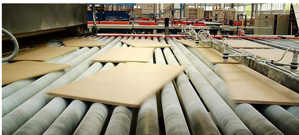
Ilustración 55 Entrada de baldosas al horno por medio de rodillos refractarios giratorios
