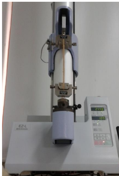
Figura 6. Forma de ubicar la probeta en el equipo: Tensión Fuente: Autor
