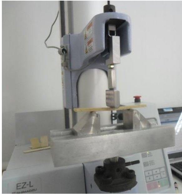
Figura 7. Forma de ubicar la muestra en el equipo: flexión Fuente: Autor
