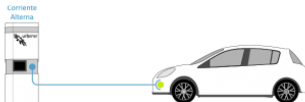
Figura 38. Modo de carga 1. [50]
