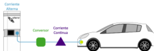
Figura 41. Modo de carga 4. [50]
