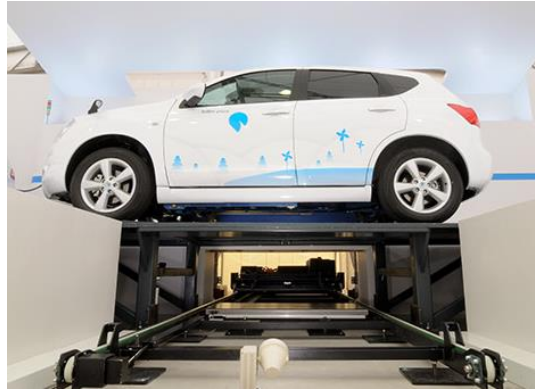
Figura 49. Sistema automático de intercambio de baterías. [54]
