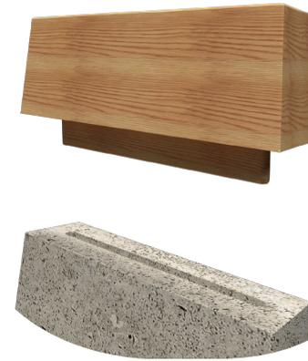
En este detalle se puede apreciar una solución técnica atípica dentro del sistema, ya que es una unión de clavijas de madera a una estructura monolítica de hormigón mediante una resina epoxi o poliepóxido.
