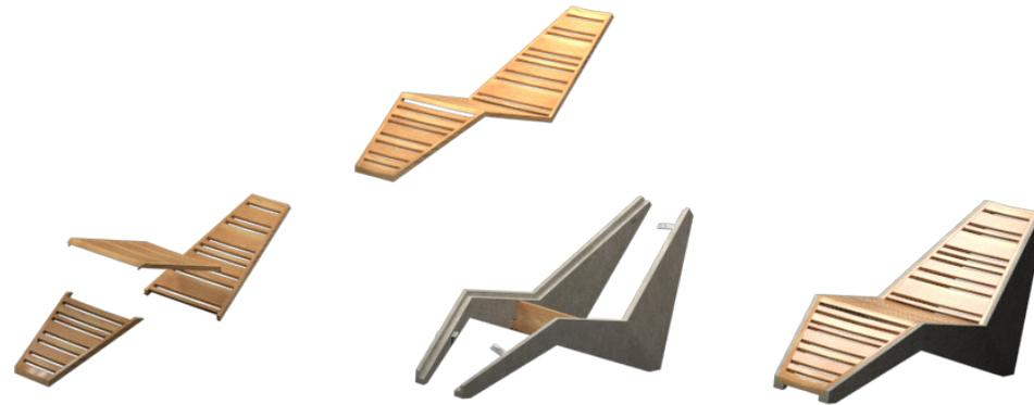
Las zonas de contacto se ensamblan por separado mediante el uso de clavijas de madera, para luego ser unidas sus partes entre sí para conformar una única pieza, tal y como se muestra.
