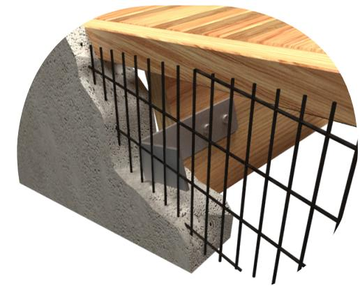
En detalle: unión mediante el angular anclado a la estructura de acero interior y la estructura de madera, a través de tornillos auto roscantes.
