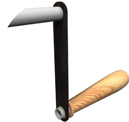
Se muestra el detalle de la manivela que hace girar la púa del asador. Se ha confeccionado con una púa (barra de acero de 20mm) unida a una pletina mediante electro-soldadura. El mango ha sido colocado mediante la inserción de un buje que permita su rotación sobre su centro.
