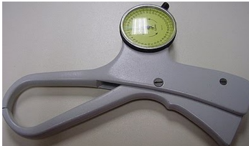
Gráfico No9. Plicómetro Fuente: Antropometrías instrumentales y medidas.pdf, 2014
