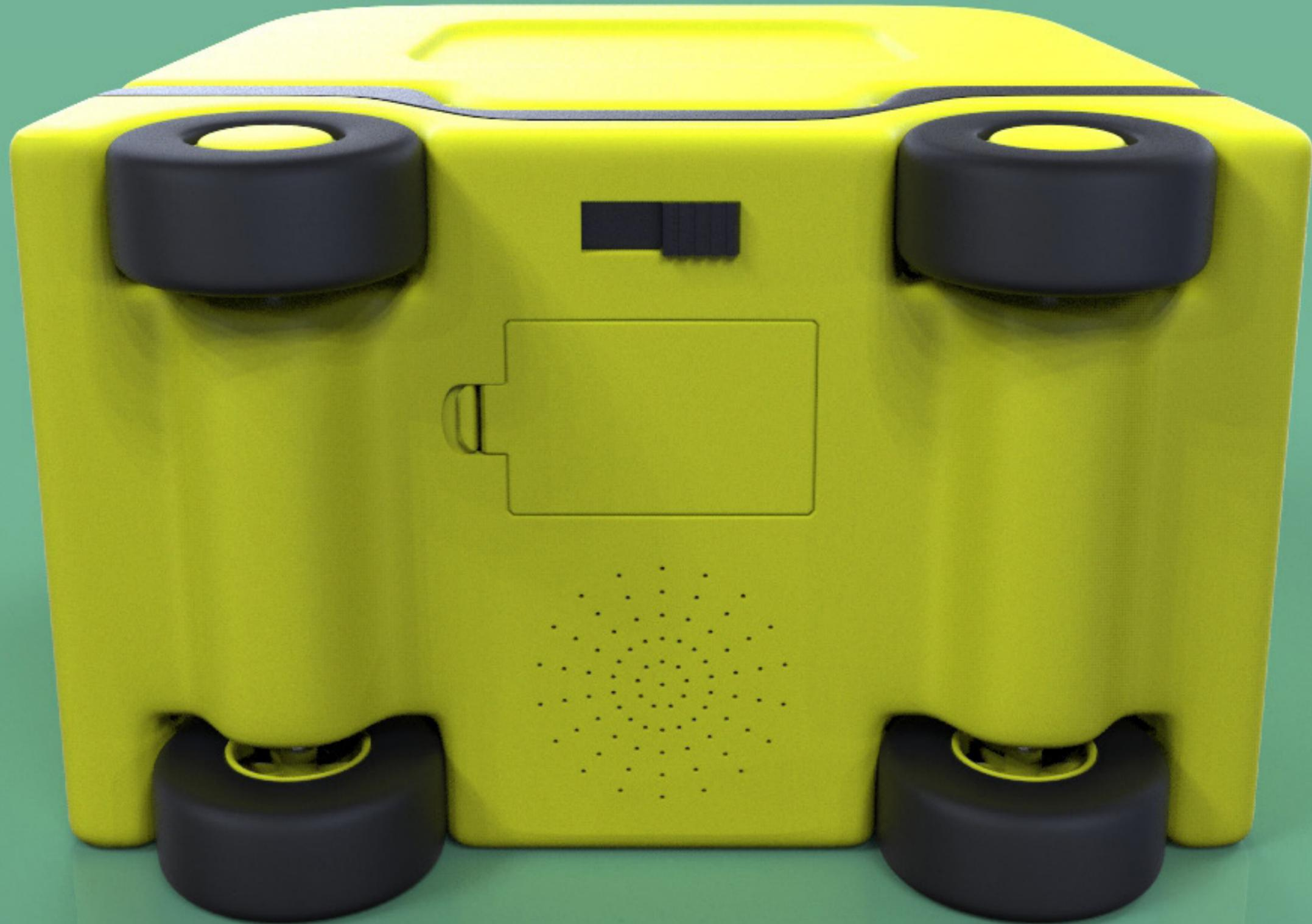
En esa zona se encuentra además un interruptor que permite desactivar tanto el sonido como las luces de manera permanente. Los sonidos se reproducen mediante una bocina de baja potencia situada a un lado del compartimento de las baterías aprovechando la distribución de los demás elementos electrónicos en esta parte para utilizar la misma placa de circuitos en su conexión.
