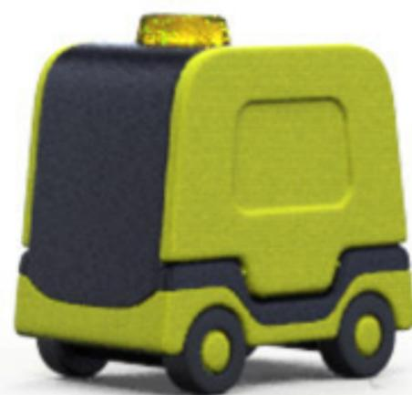
La alimentación de las partes electrónicas se realiza mediante 2 baterías AA que se insertan en un compartimento situado en la zona inferior. La extracción para el recambio se realiza retirando una tapa ensamblada mediante una patilla elástica para su fácil acceso.
