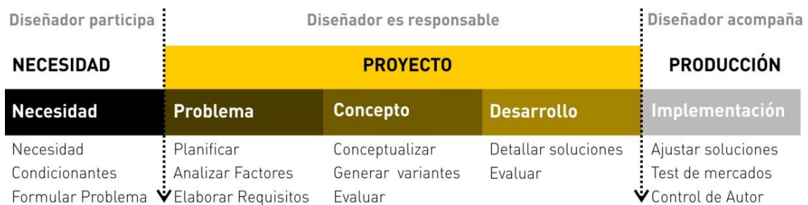
ILUSTRACIÓN 3. PROCESO DE DISEÑO INTEGRADOR FUENTE: PEÑA MARTÍNEZ, 2007
