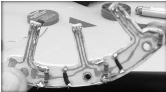
Figura 3.19. Placa para montar sensores HALL.
