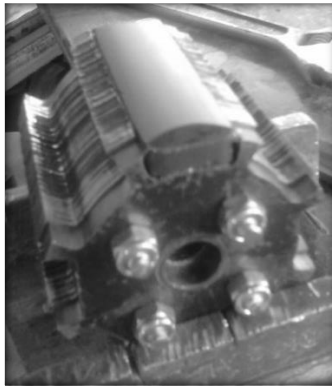
Figura 4.2. Láminas de rotor apiladas y comprimidas.
