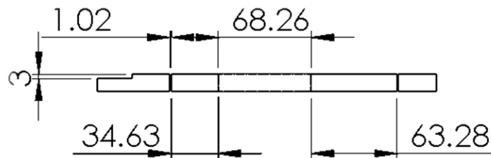
Figura 2.7. Dimensiones de la flecha para el eje del rotor.
