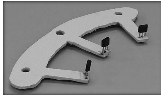
Figura 3.19. Placa para montar sensores HALL.
