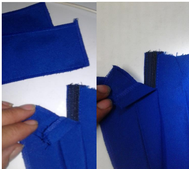
Figura N° 83 Armado del cierre
