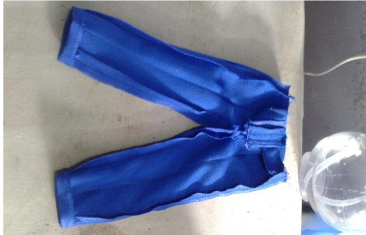
Figura N° 88 Planchado abriendo costuras, se aprovecha en planchar bastas
