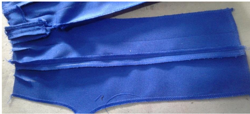
Figura N° 86. Planchado abriendo costuras
