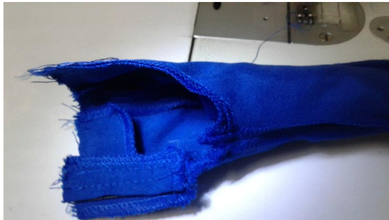
Figura N° 89 Unión de tiro total
