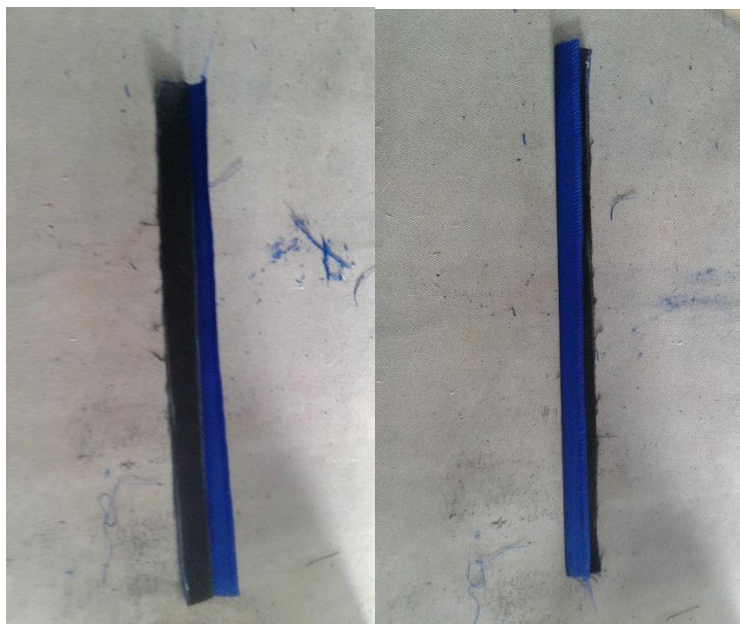
Figura N° 84 Armado de la pretina
