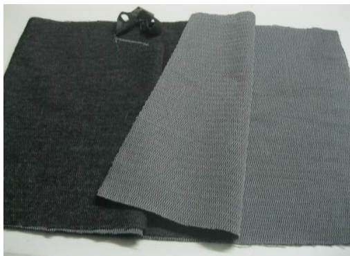
Figura N° 31. Entretela termohadesiva (brinco) Fotografía tomada por la expositora
