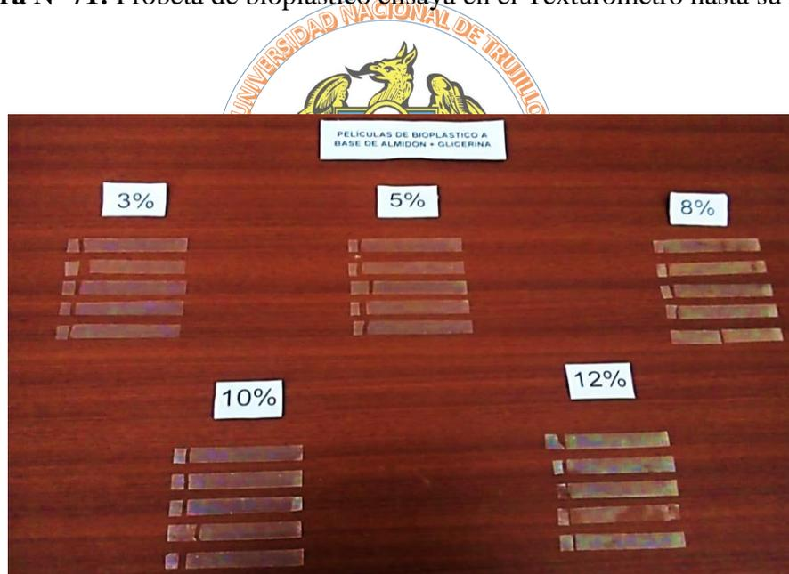
**Figura N° 72:** Probetas de bioplástico fragmentadas luego del ensayo de tracción.
