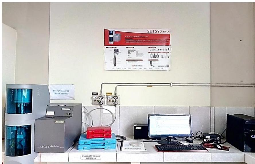
**Figura N° 67:** Ensayo de DSC y TG a las muestra de bioplástico a base de almidón de papa en el equipo analizador térmico SETARAM
