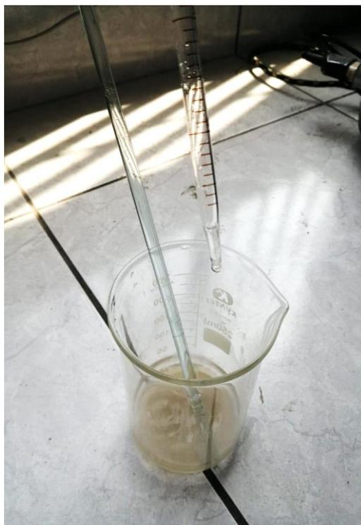
**Figura N° 61:** Agregando el NaOH a 0.1 molar para neutralizar la mezcla.
