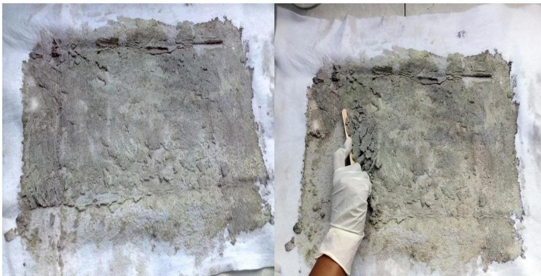
**Figura N° 51:** Almidón seco por 24 horas a temperatura ambiente y su posterior retirado de la tela fieltro.
