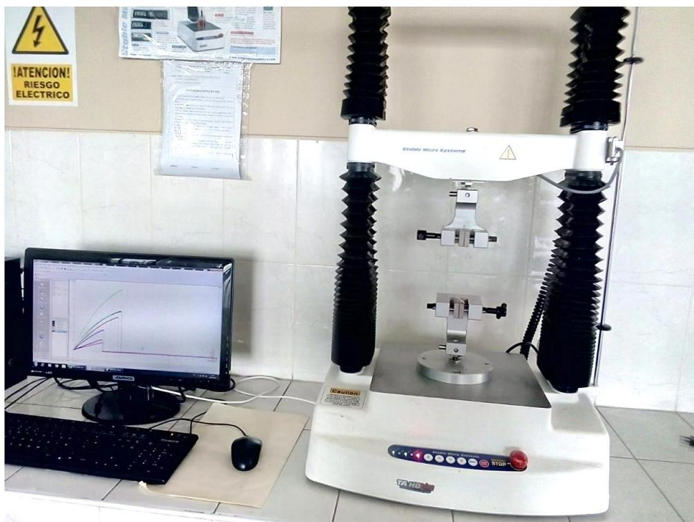
Figura N° 69: Ensayo de resistencia a la tracción y % deformación en el Texturometro.
