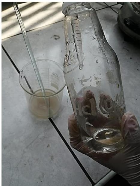
**Figura N° 59:** Agregando el HCl a 0.1 Molar a la mezcla de almidón de papa + agua destilada.
