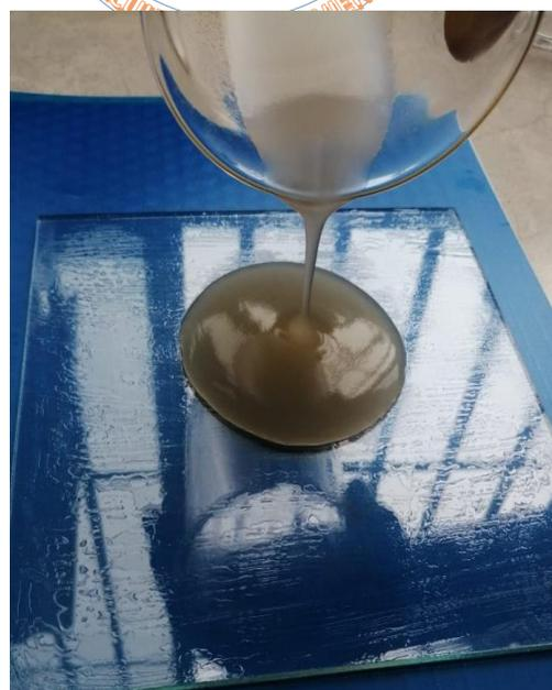
**Figura N° 62:** Bioplástico a base de almidón vía casting.
