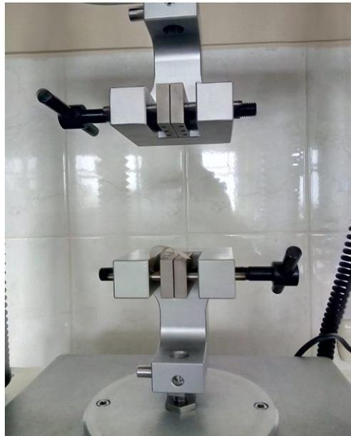
**Figura N° 71:** Probeta de bioplástico ensaya en el Texturometro hasta su rotura.
