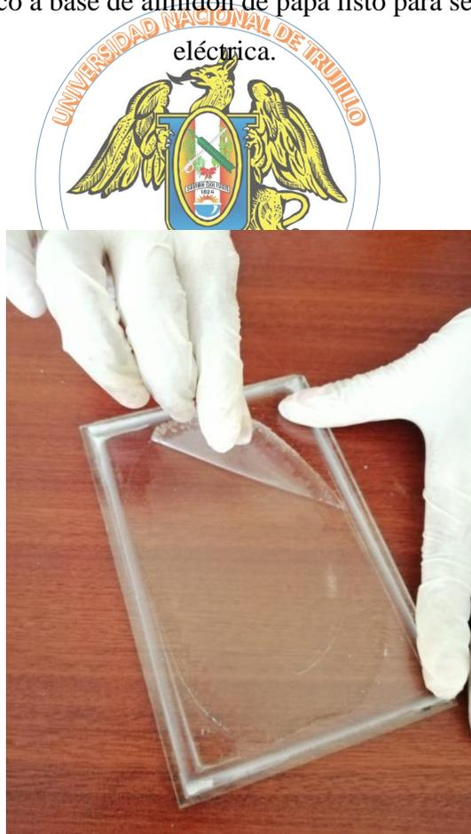
**Figura N° 64:** Desmoldando la película de bioplástico a base de almidón de papa.
