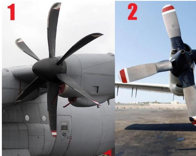
**Figura 3-17:** Hélice con paso máximo (1) y con paso mínimo (2). [50]
