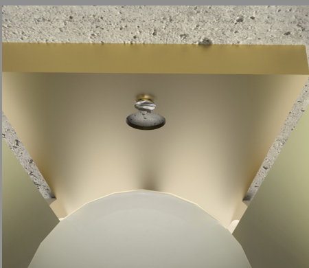
Anclaje a la pared colgado mediante una abertura en la estructura base
