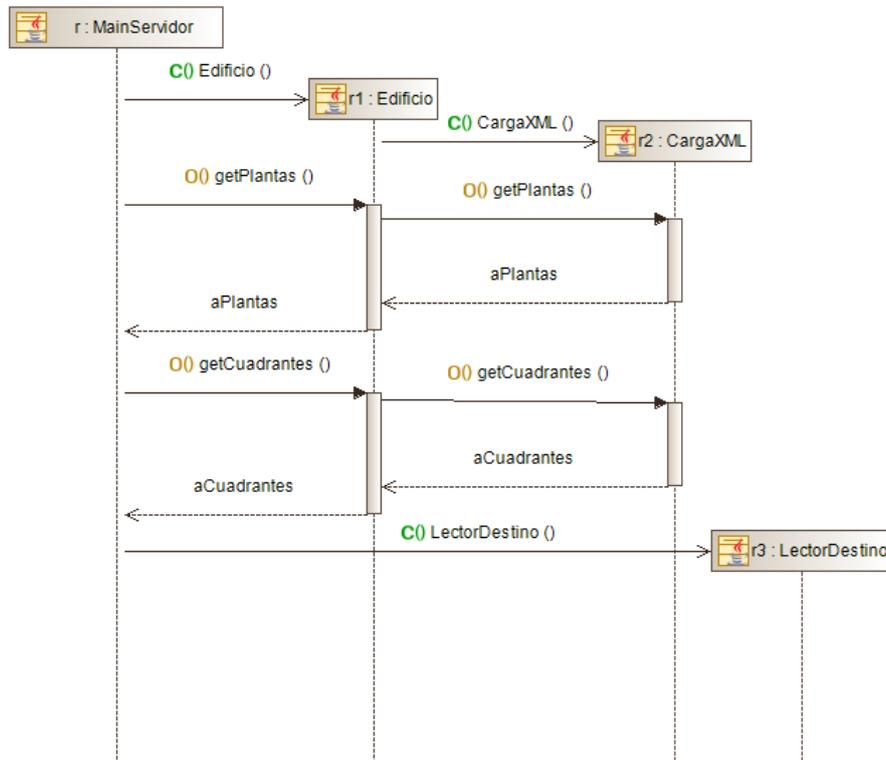
Figura 6.1: Diagrama de secuencia para el arranque del servidor.
