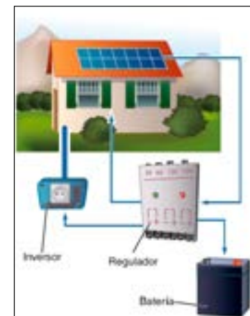
Instalación solar autosuficiente
