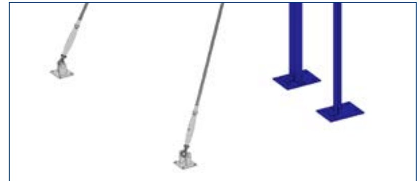
Cables tensores para brindar mayor resistencia a la estructura.
