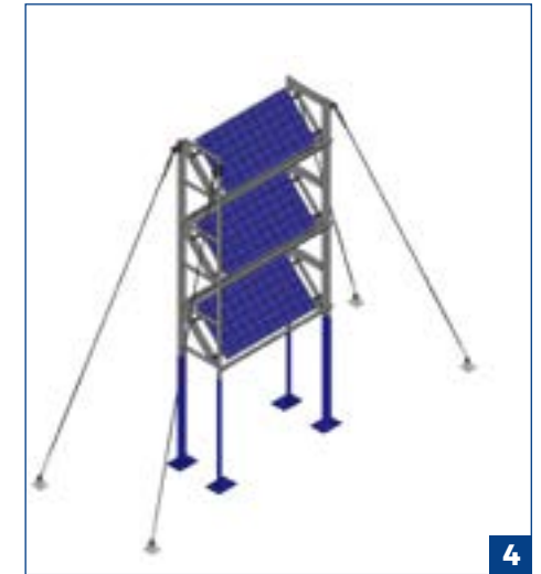
Colocar cables tensores.
