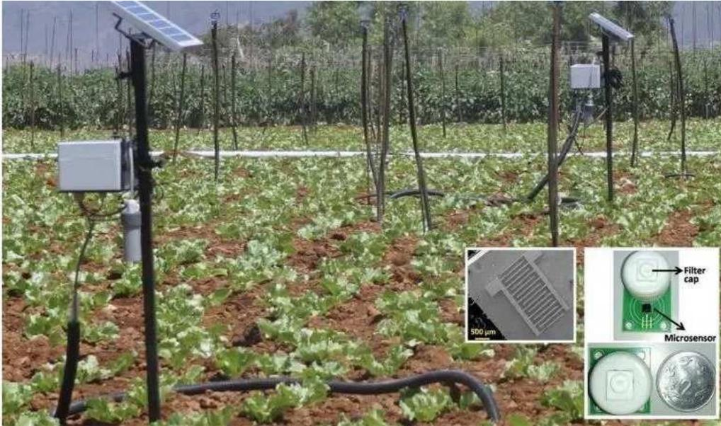
Figura 6.17: Sensores de humedad basados en el grafeno [57].
