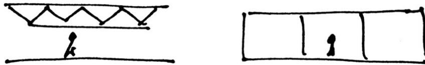
Imagen 194: Esquema de edificio con estructura reticulada y con viga Vierendeel, Cecil Balmond. Ilustración extraída de "S, M, L, XL" (Koolhaas et al., 1995, p.677).
