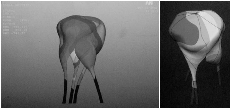
Imagen 161: Análisis por ordenador de la "D-Tower" con un programa de elementos finitos. Ilustraciones extraídas de "NOX: machining architecture" (Spuybroek, 2004, p.163).
