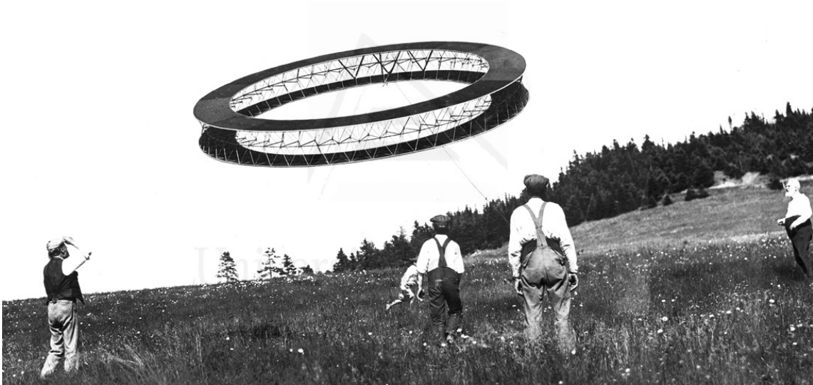
Imagen 38: Máquina voladora diseñada por Alexander Graham Bell según el principio tetraédrico. Imagen realizada con ilustración extraída de Internet < http://photography.nationalgeographic.com/photography/photos/national-geographic-milestones/#/tetrahedral-truss-kite_245_600x450.jpg >.
