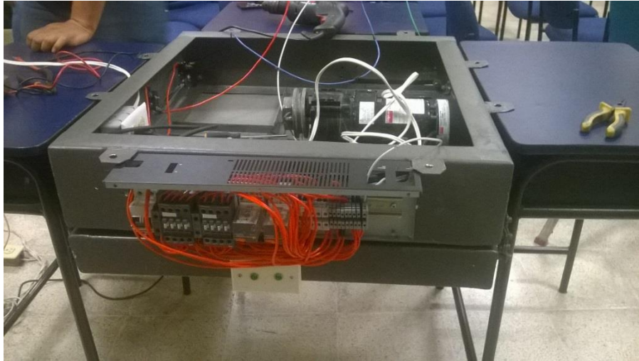
Fig. 58: Elementos de control del motor
