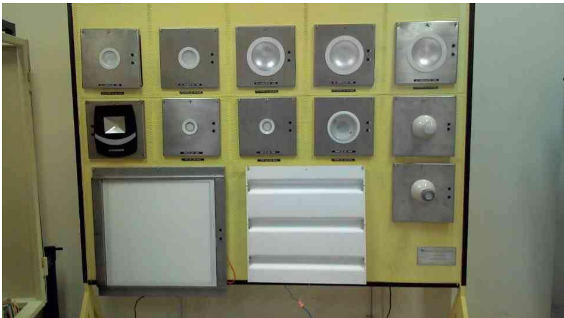
Fig. 89: Tablero para exhibición de luminarias LED
