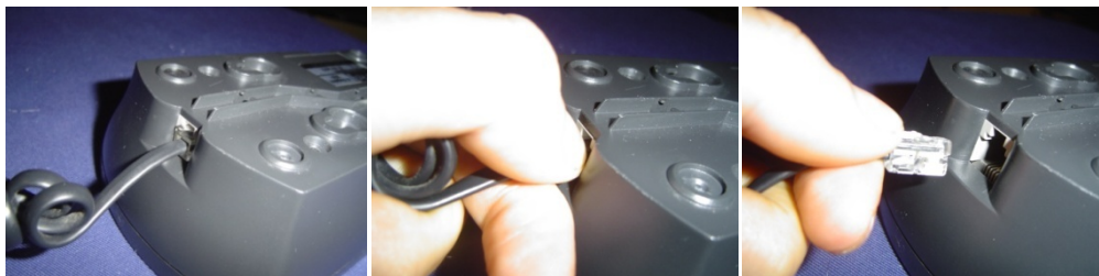
Figura 5.2: Extracción Snap 1, clavija teléfono de fácil acceso
