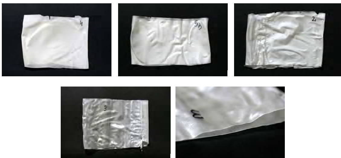
Figura 5.5. Películas a base de almidón de maíz nativo (N), acetilado (A) y glicerol (G) obtenidas por extrusión y soplado, Tabla 5.1.
