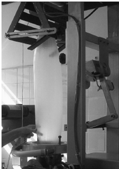
Figura 5.4. Obtención de películas por el método de soplado a partir de pellets a base de almidón de maíz nativo y acetilado y glicerol como plastificante.
