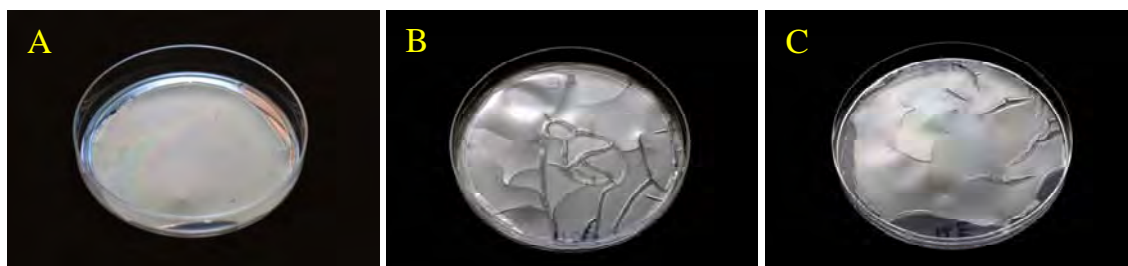
Figura 3.5. Películas obtenidas a partir de almidón de maíz químicamente modificado: A: acetilado, B: acetilado entrecruzado y C: hidroxipropilado entrecruzado.
