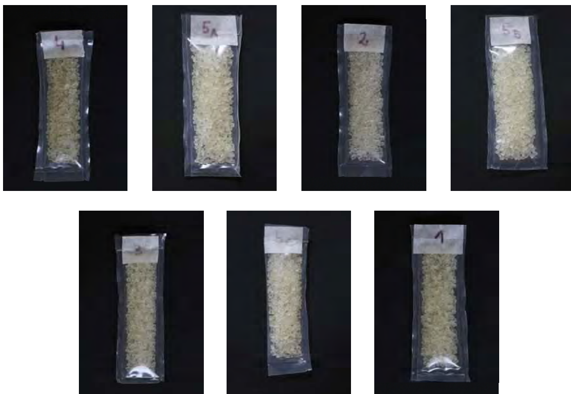
Figura 5.3. Pellets obtenidos a partir de mezclas de almidón de maíz nativo (N), acetilado (A) y glicerol (G), Tabla 5.1.
