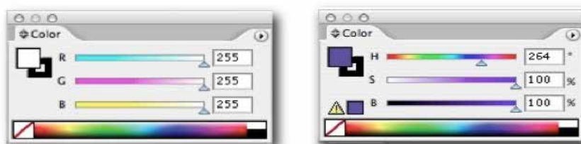
Las paletas de color basadas en los sistemas RGB -Red, Green, Blue- (izq.) y HSB -Hue, Saturation, Balance- (der.) definen los sistemas de color más empleados en el entorno hipermedia.
