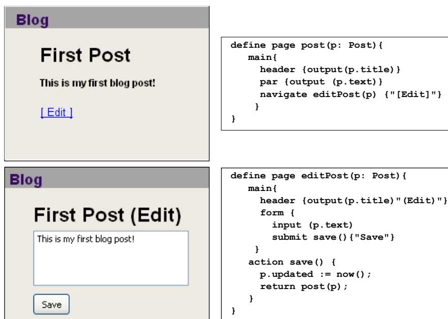
Figura 5.11: Ejemplo del constructor navigate en WebDSL
