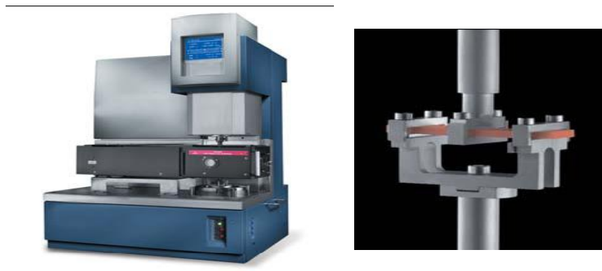
Figura 2.4.3. Reómetro empleado para los ensayos de DMA. RSA3 TA instruments.
