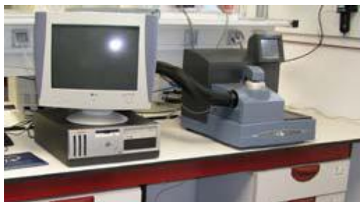
Figura 2.4.2. Calorímetro empleado para los ensayos de DSC. Q100 TA instruments.
