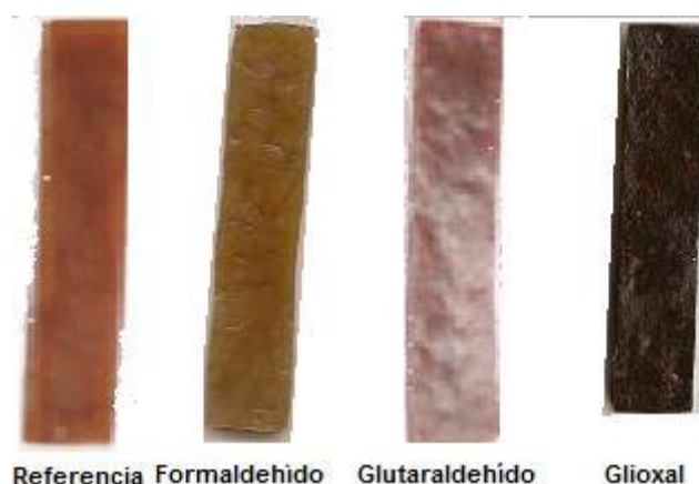
Figura 3.2.9. Probetas de bioplástico WG/GL/agua 50/18 con adición de aldehídos (3%).
