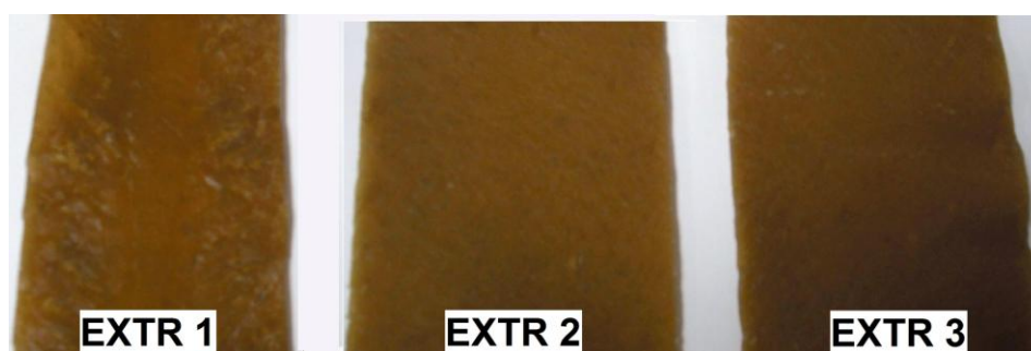
Figura 3.4.3. Láminas de bioplástico obtenidas por extrusión del sistema WG/GL/agua a pH 6 bajo diferentes perfiles de temperatura.
