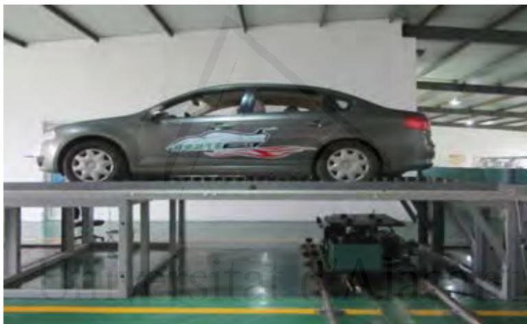
*Figura 7: Prototipo del sistema de intercambio desarrollado en el Instituto de la Energía Eléctrica de Shandong. Fuente: [Sha]<sup>10</sup>*
