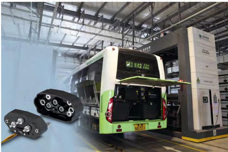
*Figura 16: Autobús eléctrico de la ciudad china de Qingdao que funciona bajo el modelo de intercambio de baterías, colocado junto a estación de intercambio. Fuente: [Qin]<sup>17</sup>*
