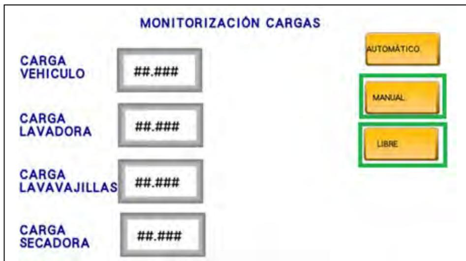
Figura 83: Aspecto de la pantalla táctil Omron NB7W-TW00B. En la parte derecha, los 3 modos de funcionamiento disponibles. Fuente: Elaboración propia.
