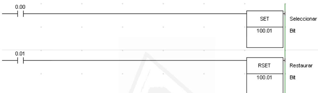
Figura 76: Ejemplo de Instrucción SET/RSET en CX-Programmer. Fuente: Elaboración propia.
