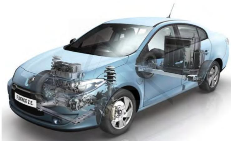
*Figura 43: Disposición del motor eléctrico y la batería de tracción en el Renault Fluence Z.E. Fuente: [RLe]<sup>38</sup>.*
