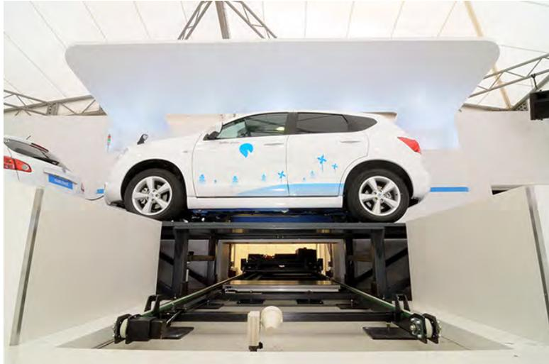
*Figura 8: Sistema de intercambio adaptado al formato comercial por Better Place. Fuente: [www.wired.com](http://www.wired.com)*
