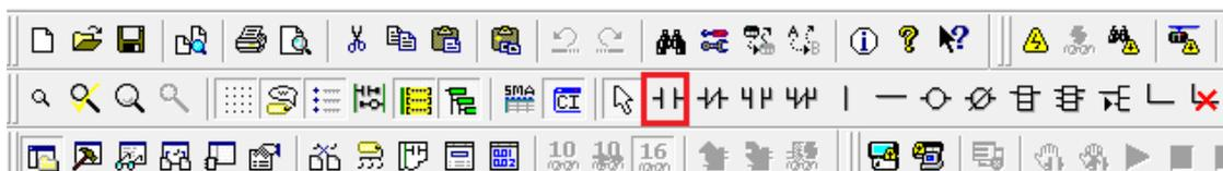
Figura 69: Símbolo de Contacto normalmente abierto en la Barra de Herramientas de CX-Programmer. Fuente: [OM2]<sup>93</sup>.
