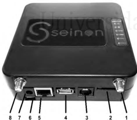
1. Conector SMA para antena externa GPRS/3G.
