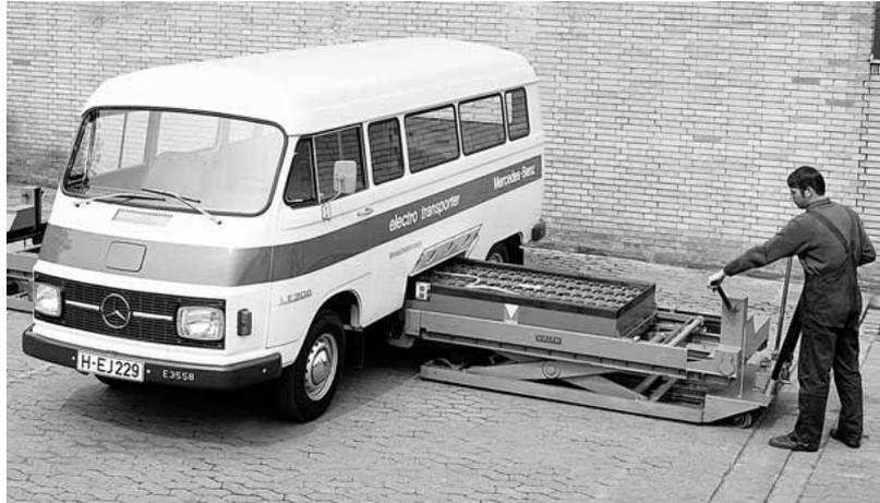
*Figura 6: Primera experiencia del Intercambio de Baterías, aquí se observa al técnico de Mercedes procediendo de manera rudimentaria al intercambio de la batería de este minibús. Fuente: [www.plugincars.com](http://www.plugincars.com)*
