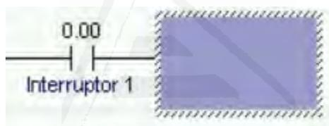
Figura 70: Inserción de Contacto normalmente abierto en CX-Programmer. Fuente: [OM2]<sup>93</sup>.
