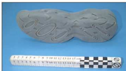
Figs. 66 y 67. Ejemplos de detalles de piezas hechas con prototipado rápido: stereolithography.
