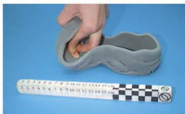
Figs. 66 y 67. Ejemplos de detalles de piezas hechas con prototipado rápido: stereolithography.
