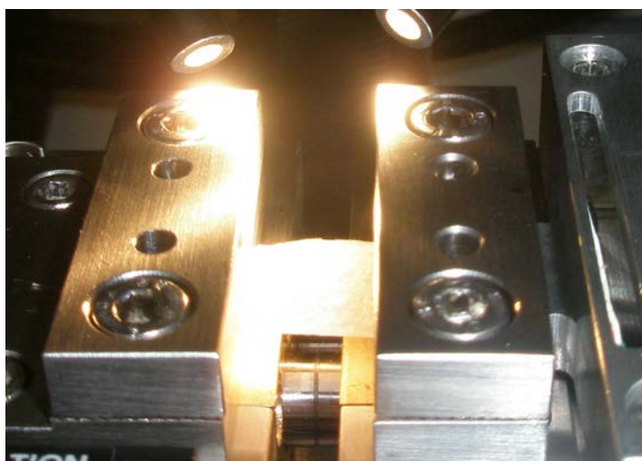
Figura VI-26. Estudio de cizalla de los films adhesivos mediante dinamómetro informatizado Deben Gatan Microtest Tensile Tester [C.2KN], con velocidad del motor de 0,5 mm/s.
