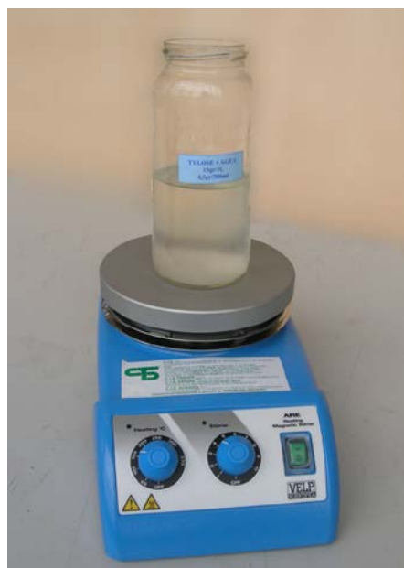
Figura III-9. Hidratación de Metilhidroxietilcelulosa, para su empleo como espesante de resinas acrílicas en intervenciones del soporte textil.
