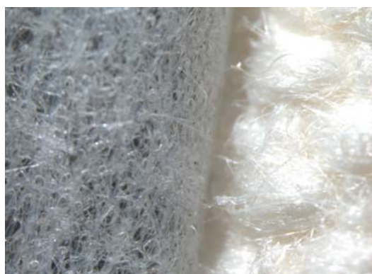
Figura 3. Imagen mediante microscopía óptica (8x) del ensayo de pelado de la muestra (PI-K)Tnt
