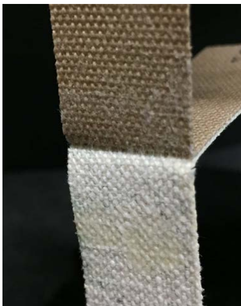
Figura VI-36. Detalle de la fuerza de pelado de la probeta (P_K 90 _aT 0,7 ) durante el desarrollo del ensayo.
