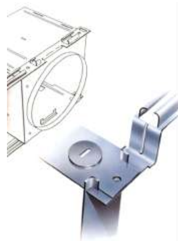
Figura 26. Aplicación del clinchado en muebles metálicos.
