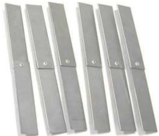
Figura 79. Aspecto final de las uniones remachadas.
