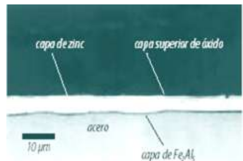
Figura 57. Corte micrográfico de un recubrimiento galvanizado, en el que se puede apreciar su estructura.
