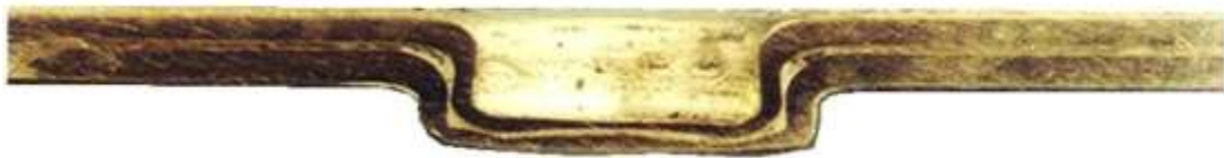
Figura 64. Sección detalle de una unión clinchada.
