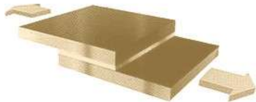
Figura 43. Unión a solape simple. Diseño normal sin optimizar.
