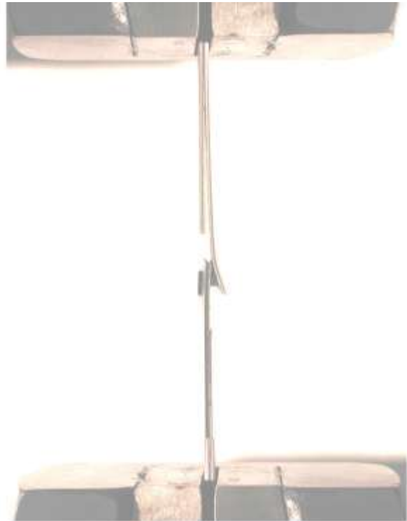
Figura 90. Situación de la probeta en las mordazas de las garras de la máquina.
