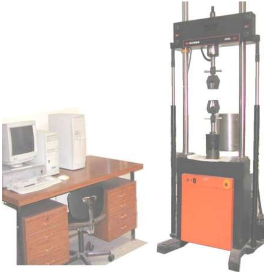
Figura 87. Conjunto de dispositivos de accionamiento y control de la máquina de tracción.
