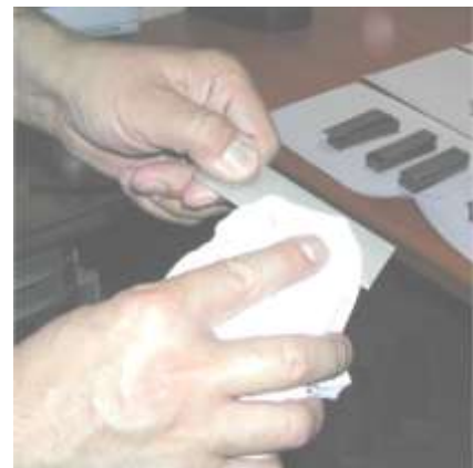
Figura 68. Prelimpieza de las superficies a unir.
