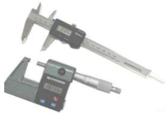
Figura 80. Instrumentos utilizados para la medición de las uniones.
