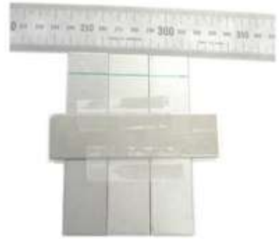
Figura 72. Unión temporal con celofán y marcado de la zona donde se aplica el adhesivo, a 12.5 mm del extremo.
