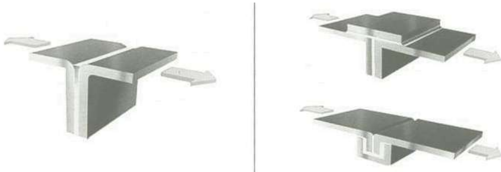
Figura 38b. Diseños para minimizar las cargas de desgarro.
