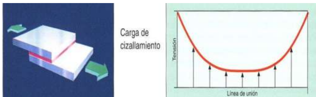
Figura 61. Unión seleccionada y curva de tensiones a lo largo de la línea de unión.
