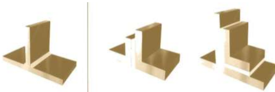
Figura 39b. Diseño para maximizar el área de la unión en caso de uniones en ángulo.
