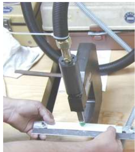
Figura 75. Máquina de clinchado realizando la operación de unión.
