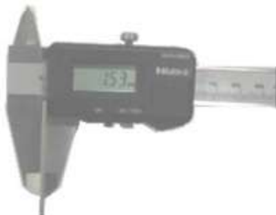
Figura 81. Medida del espesor de las chapas con calibre.
