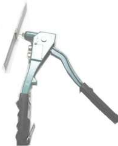
Figura 78. Remachadora preparada para realizar la unión con remache.
