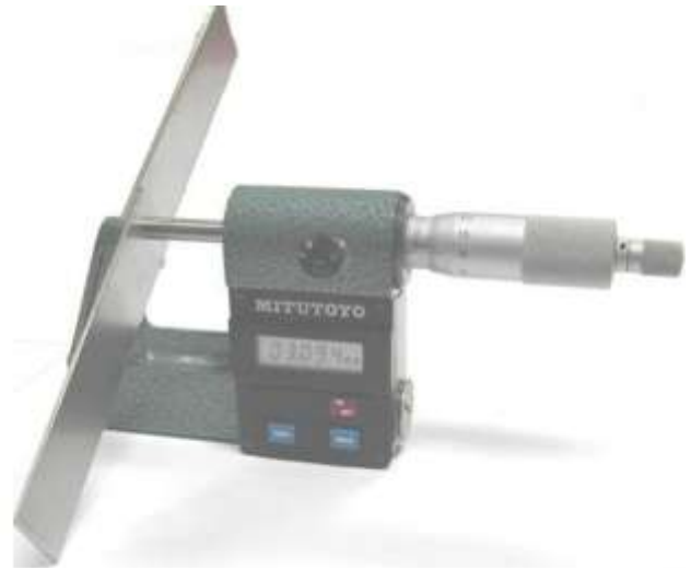
Figura 84. Medida de la unión después de realizada con micrómetro.
