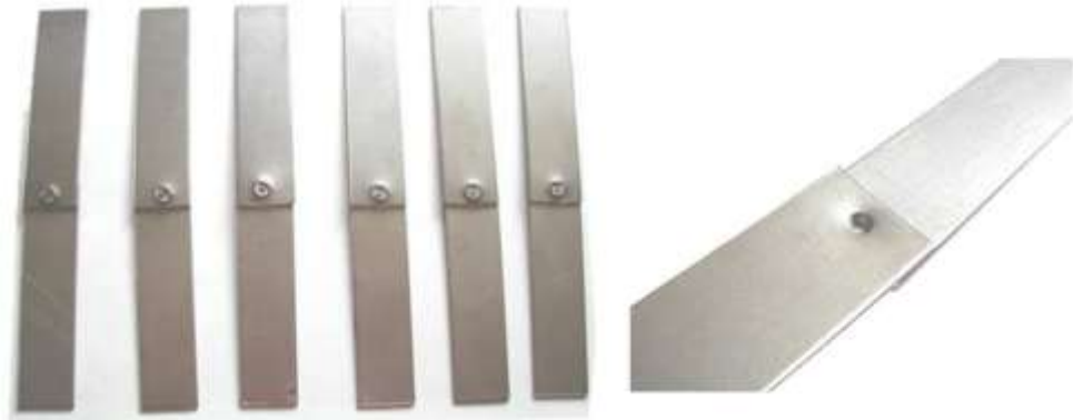
Figura 76. Forma de la unión realizada por clinchado.
