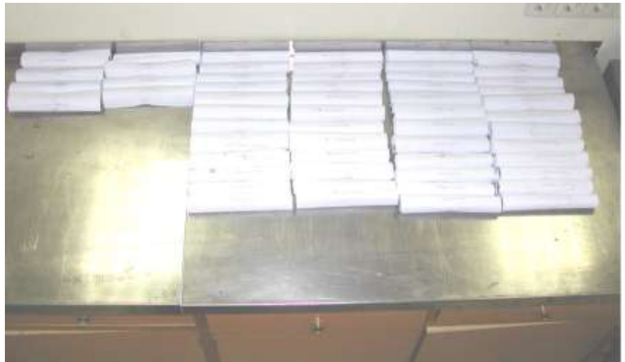
Figura 71. Paquetes de 12 chapas preparadas para aplicar el adhesivo.
