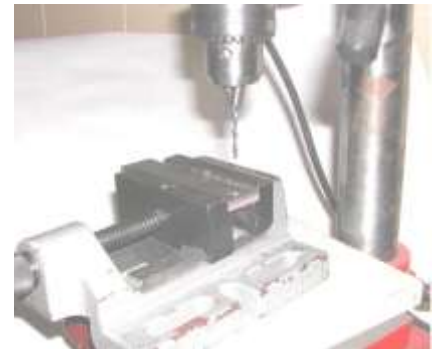
Figura 77. Taladrado de los agujeros a diámetro 4 mm para luego introducir el remache.
