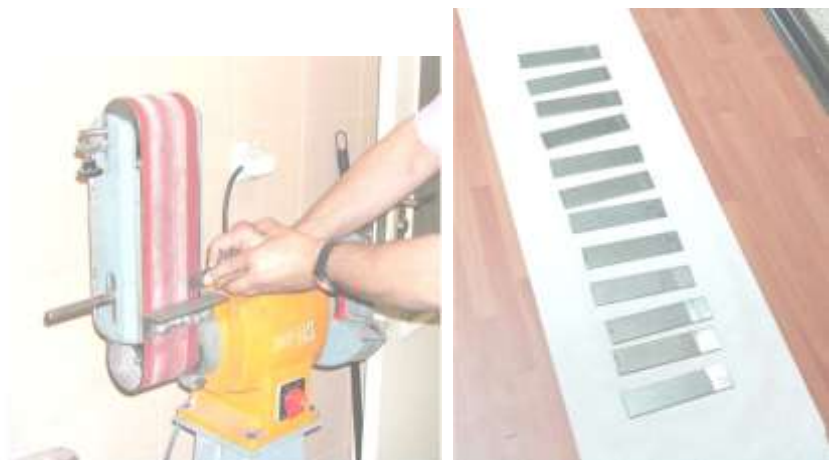
Figura 69. Proceso de lijado de chapas con superficie original laminada.
