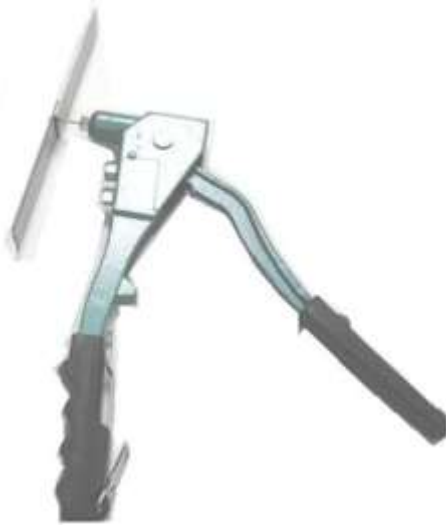
Figura 67. Herramienta de remachar en posición de ejecución del remache.
