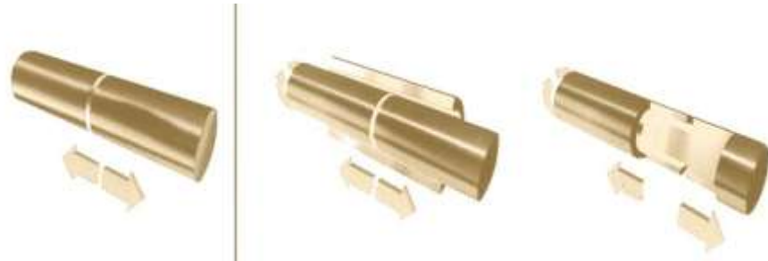
Figura 39a. Diseño para maximizar el área de la unión en caso de cargas de tracción en ejes macizos.
