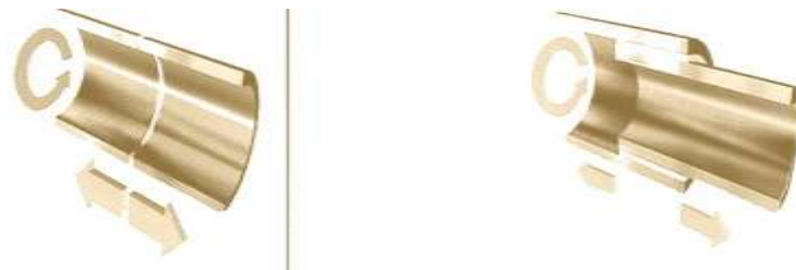
Figura 39c. Diseño para maximizar el área de la unión en caso de cargas de tracción y torsión.
