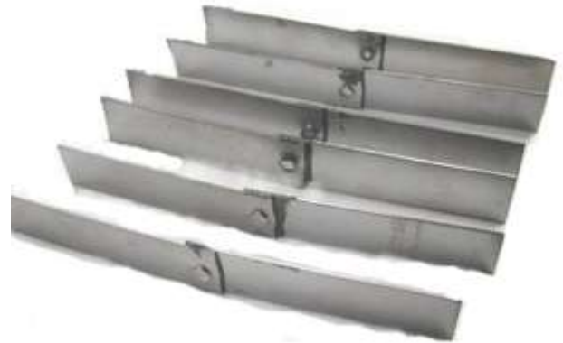
Figura 62. Unión mixta: Adhesivo mas clinchado.
