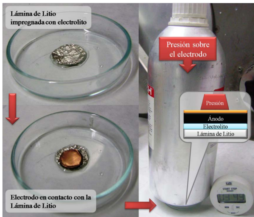
Figura 3.7. Método de activación por contacto
