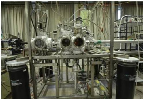
Figura A.2: Fotografía del sistema experimental VT-STM instalado en el Departamento de Física de la Materia Condensada en la Universidad Autónoma de Madrid.
