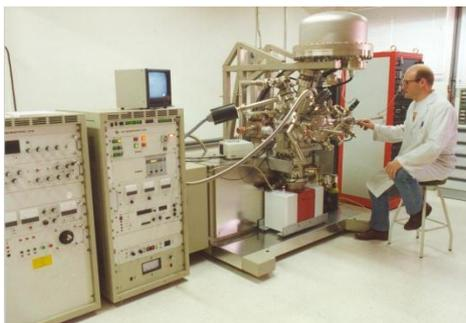
Figura A.1: Imagen del equipo XPS situado en el Instituto de Catálisis y Petroquímica (ICP) del CSIC, empleado para el análisis de la pastilla del COF-8 exfoliado.
