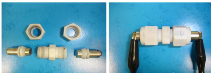
**Figura 8.2** Fotografías de la celda Swagelok utilizada para la construcción de las baterías de ion-Li.
