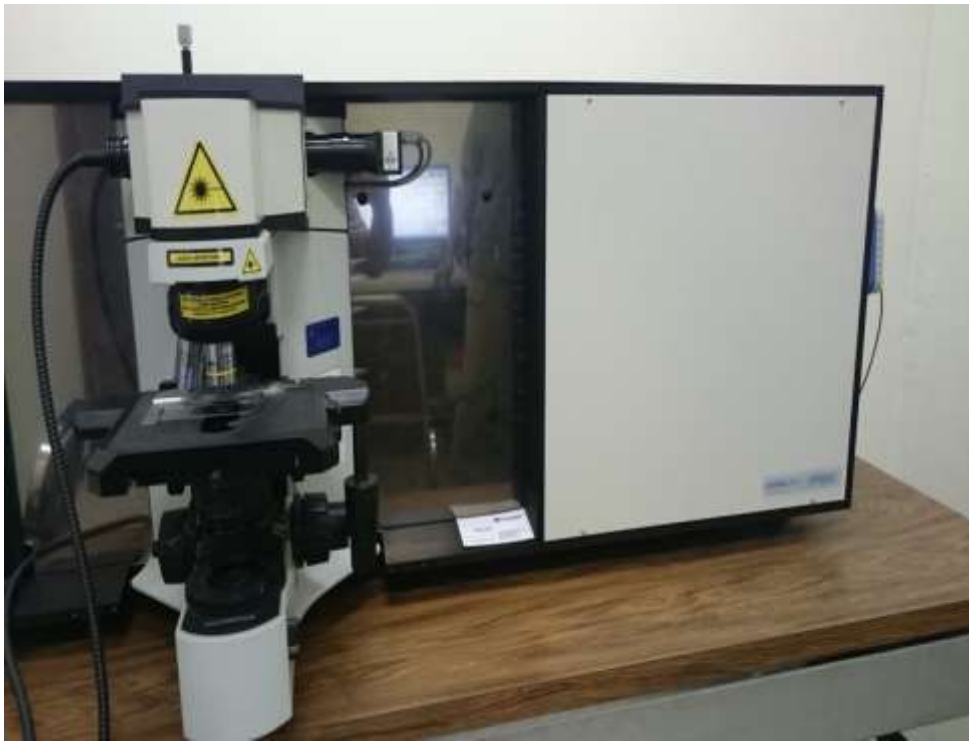
Fig. 2.1 Foto del equipo de espectroscopia Raman HORIBA modelo HR800 en las instalaciones de la SEES, CINVESTAV.
