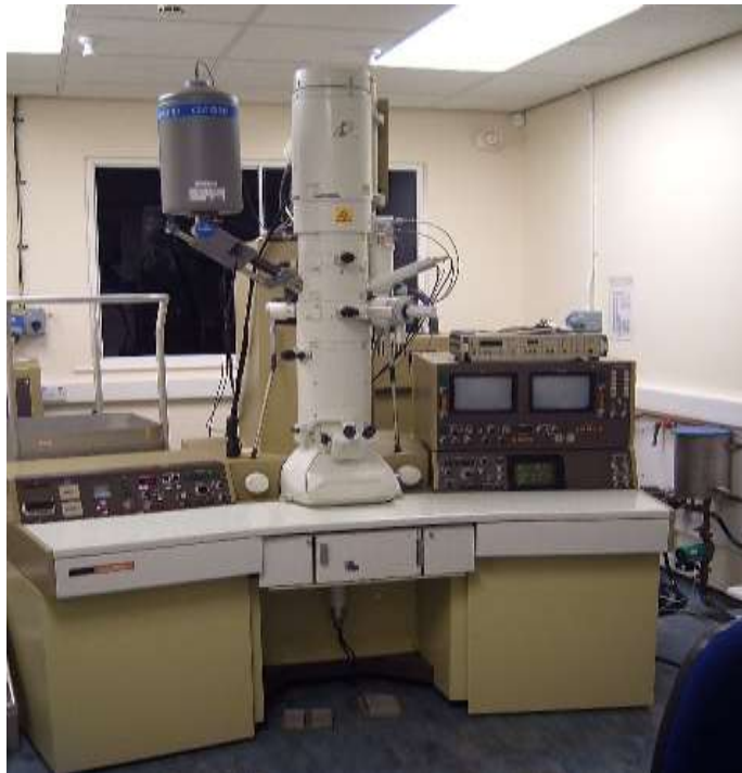
Fig. 2.6 Ejemplo de un equipo TEM, JEOL-JEM-2010 , instalado en el departamento de Física, CINVESTAV
