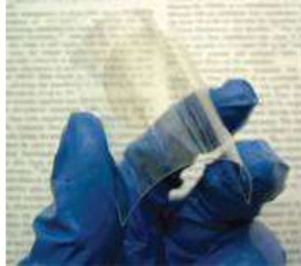
Fig. A.1.1 Lamina de grafeno que se puede flexionar y mantiene sus propiedades.
