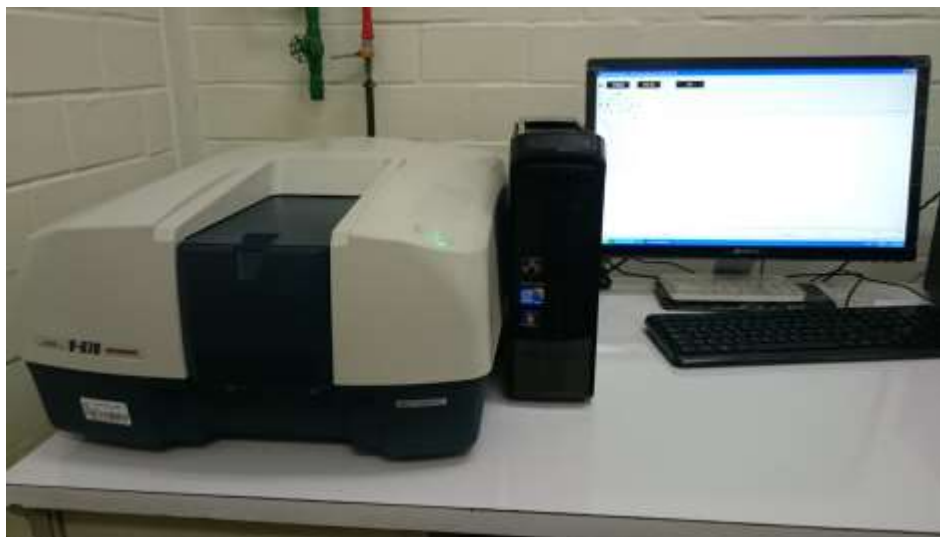
Fig. 2.5 Foto del equipo UV-Vis, JASCO modelo V-670 que se encuentra en las instalaciones de la SEES, CINVESTAV.
