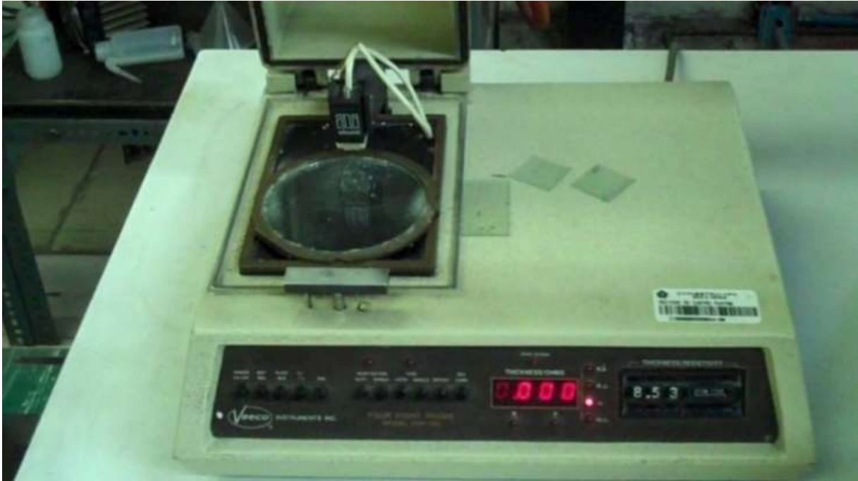
Fig. 2.11 Equipo de medición marca Veeco para la resistencia de cuadro, se encuentra en las instalaciones de la planta piloto SEES
