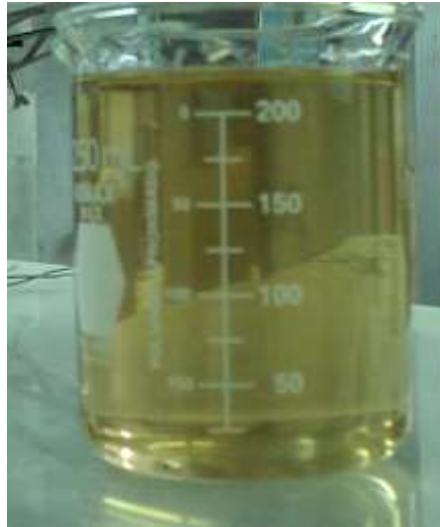
Fig. A.3.1 Síntesis de GO mediante método Hummer's, películas en suspensión obtenidas en el laboratorio de la planta piloto de la SEES
