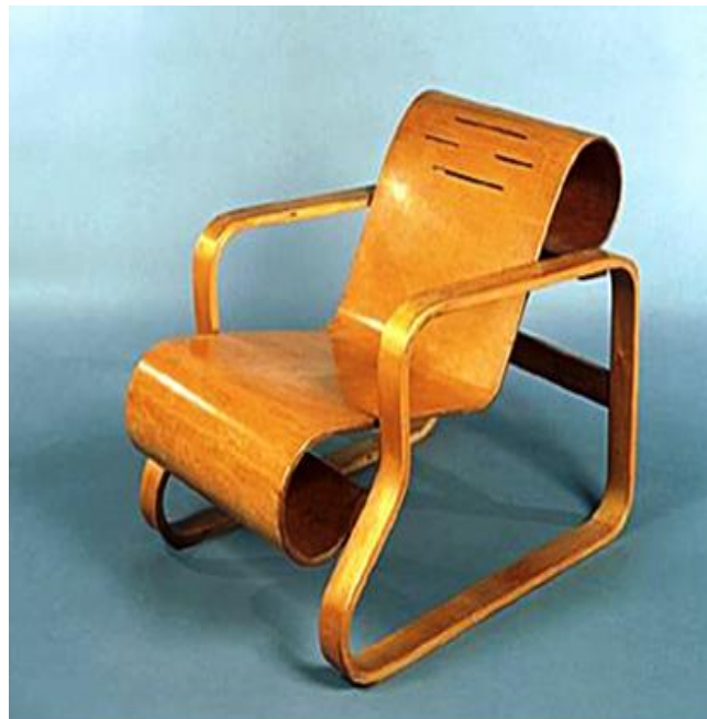
Fig. 8.- Silla conformada mediante la superposición de finas láminas de madera, pegadas y prensadas para que tomen la forma de un molde para conformar.
