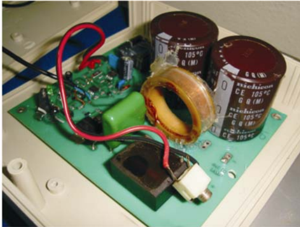
Fig. 3.6. Interior del invento: capacitores, fuente, transformador y PCB.
