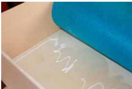
En esta imagen se acaba de colocar la cola blanca, para la extensión de la misma con una brocha y proceder al pegado de la tela en la madera.
