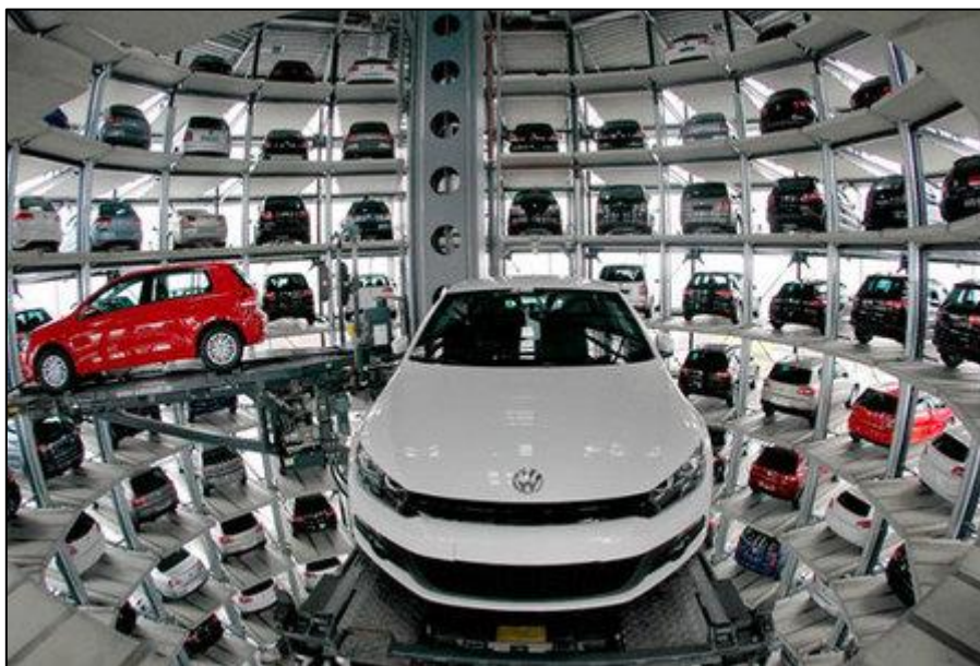
Ilustración 6 - Ejemplo de un parking robotizado
