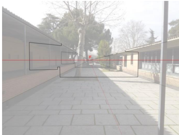
Figura 26. Definición de la sección: Relación de la proporción alto/ancho. Traslación de medidas en planos paralelos al plano del cuadro.
