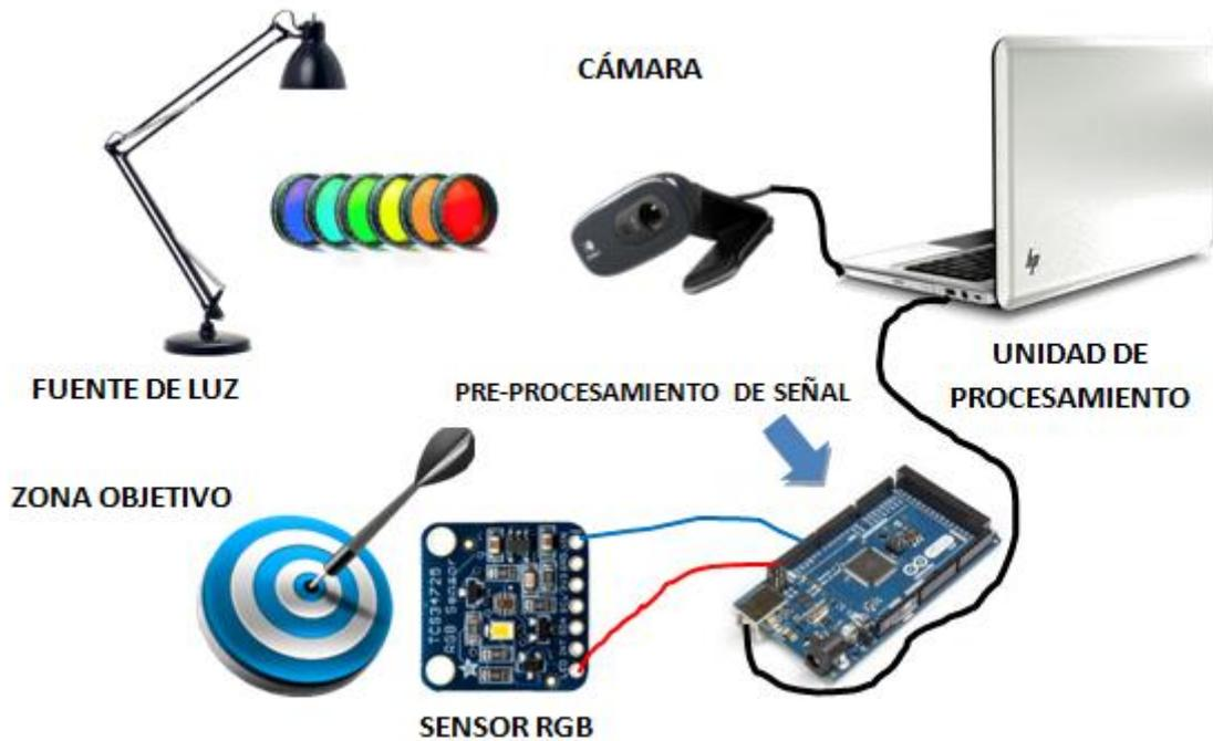
Figura 13 –Arquitectura principal del prototipo
