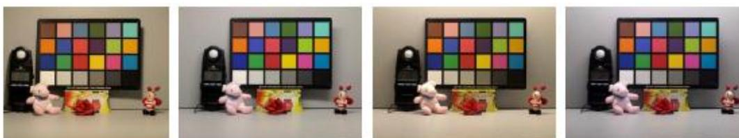
**Figura 7** – Escena tomada bajo diferentes condiciones de iluminación (Iluminador A, TL84, U30 y D50) con Macbeth color checker insertado
