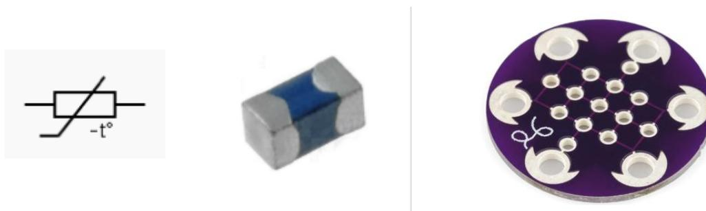
Figura 16. Símbolo e imagen termistor NTC SMD. Protoboard Lilypad Small Fuente: <https://www.sparkfun.com/>
