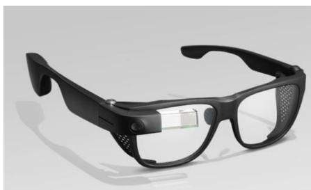
Figura 5. Google Glas, gafas con conexión a internet, cámara y pantalla. Fuente: <https://www.google.com/glass/start/>
