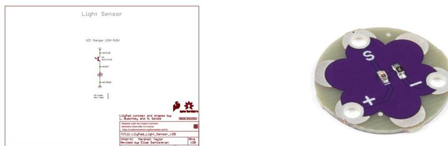
Figura 15. Esquema eléctrico e Imagen del LilyPad Ligth Sensor .Fuente: <https://www.sparkfun.com/>
