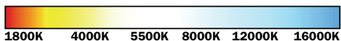
Figura 29. Referencia del color de la fuente luminosa en relación a su temperatura color. Cuanto más cálida sea la dominante, menor será su temperatura color, y viceversa. En el medio se encuentran las fuentes equilibradas.
