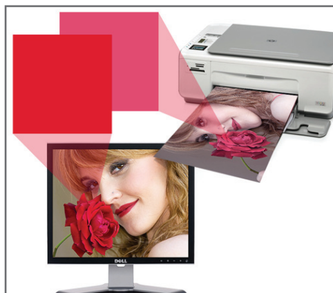
Figura 9. Como podemos ver, los mismos valores R:236; G:6; B:42 son interpretados por el monitor y la impresora de manera diferente, de ahí que los tonos de la imagen impresa no coincidan con los que estamos viendo en pantalla (Photoshop).
