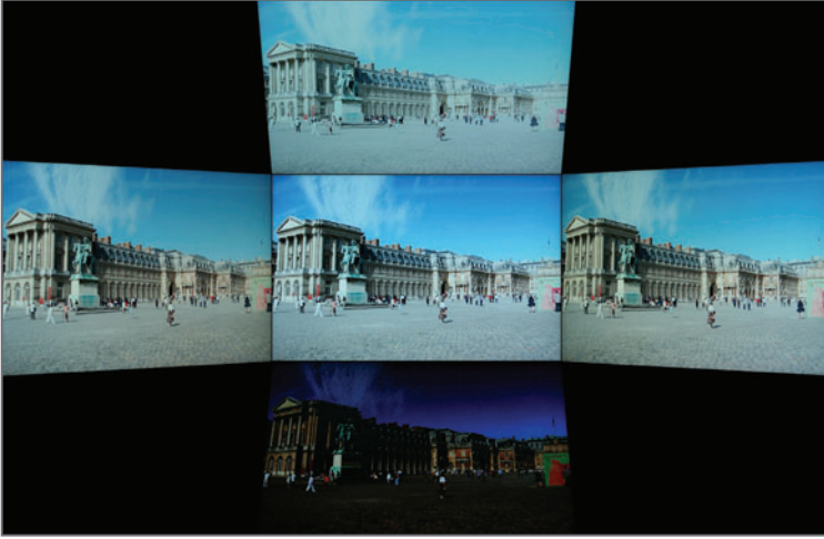
Figura 6. Los paneles de tipo TN (Twisted Nematic) y sus variantes poseen una tecnología inapropiada para el trabajo con imágenes. Es notorio el cambio de apariencia que presenta la imagen vista desde distintos ángulos.
